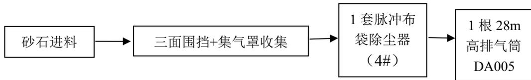
原料库砂石进料废气治理流程图
