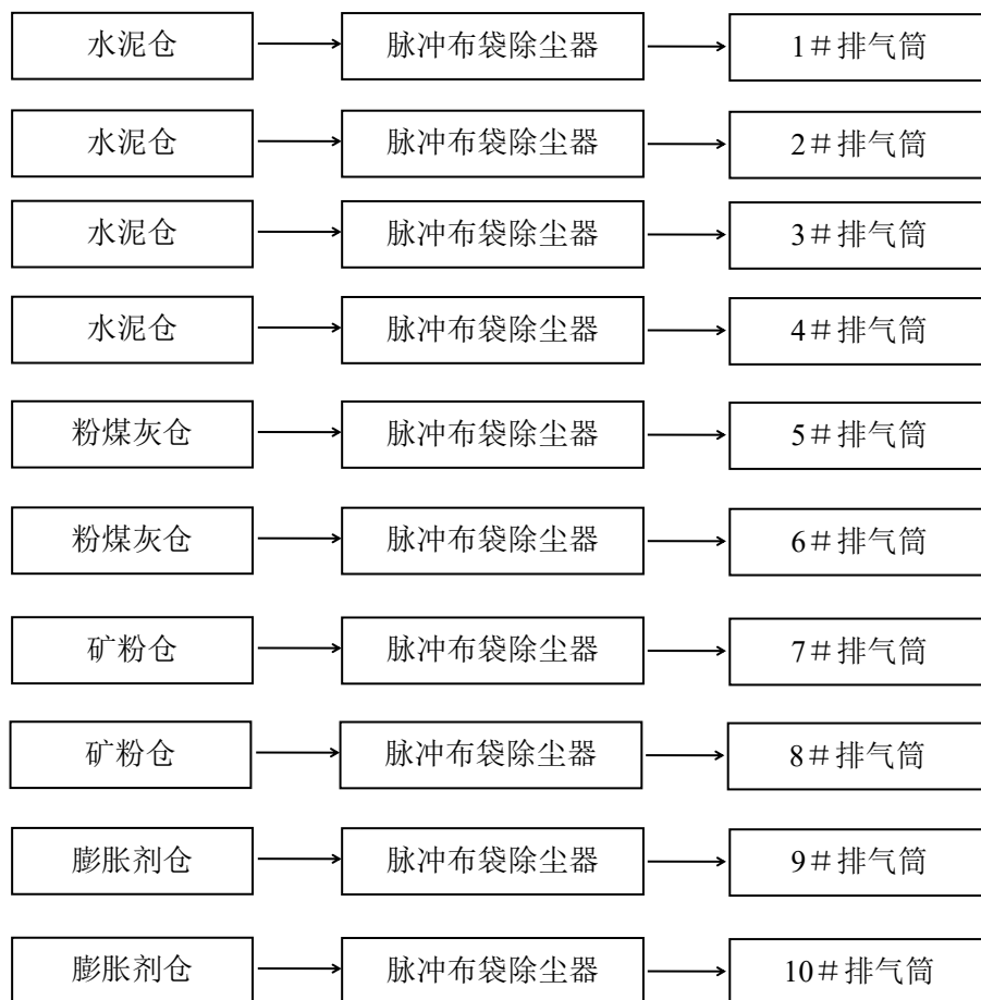
图 5 混凝土生产线筒仓治理设施图
