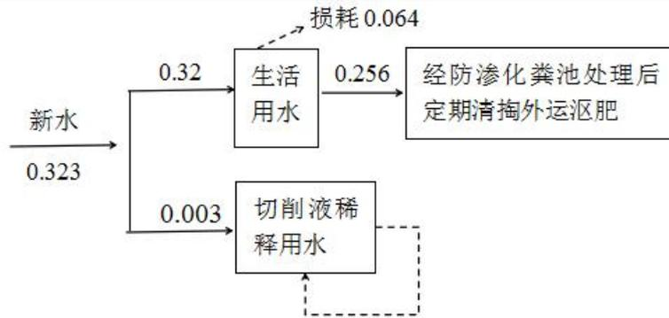
图 1-1 本项目水平衡图 单位 t/d
