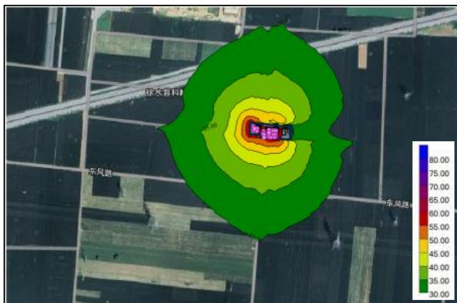
图 4-2 技改完成后全厂噪声贡献值等声级线图
